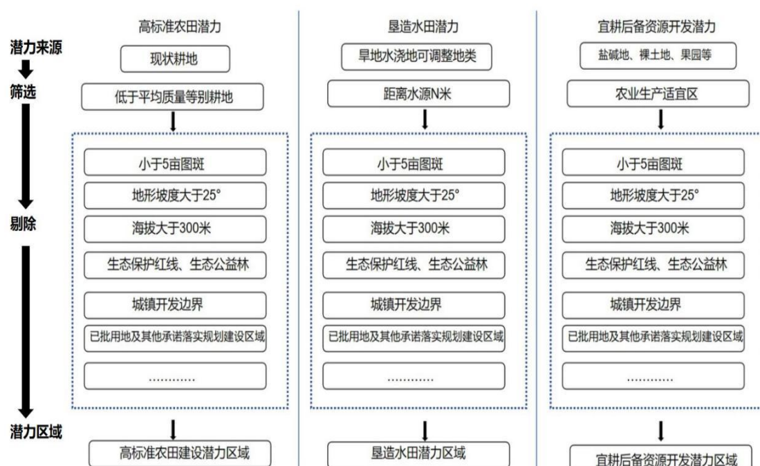
图 4-1 农用地整治潜力筛选流程
